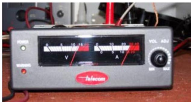
Per ultimo ho voluto infierire portando l'assorbimento a ben 30 A ed una tensione d'uscita di 13,63 volt con una caduta di tensione di 170 millivolt. Di tutto rispetto.
