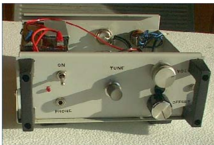
Il ricetrasmittitore QRP auto costruito da I2BZN (vedi modello illustrato su R.S. 12/2001)
