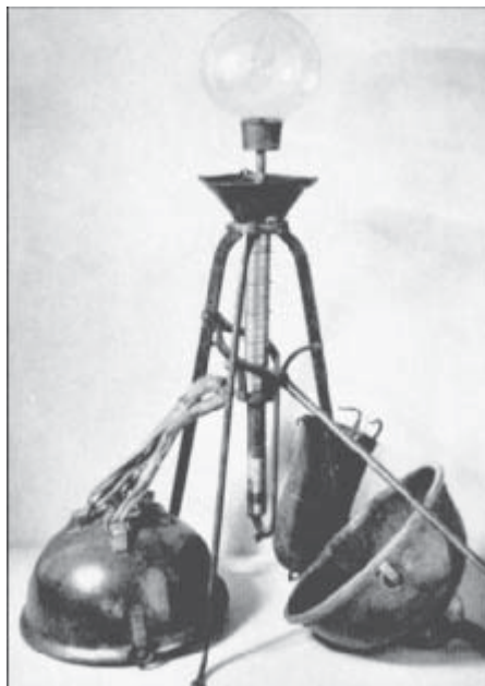
SEMISFERE DI MAGDEBURGO CON LA POMPA A VUOTO DI OTTO VON GUERICKE
