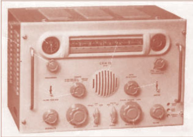
Ora, ad un anno di distanza, siamo pronti per ripartire nel lavoro completando la taratura e per mezzo di qualche condensatore NPO nel circuito dell'oscillatore, migliorarne la stabilità in frequenza.
