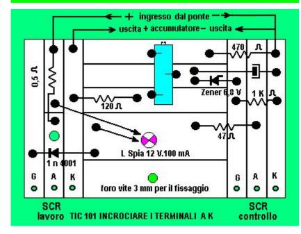
Due viti del legno per fissare l'elemento del meccano. Poi un foglio di vetronite ramata, che serve per ricavare il circuito stampato (fresato). Occorre un rettangolo da 10 per 6 centimetri, che poi va appoggiato sulla tavoletta, per poi fissarci sopra l'elemento del meccano in modo che un lato
