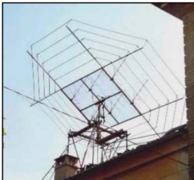
L'antenna di Torre Bert con 4 antenne yagi per i 136 MHz che se perfettamente adattate possono dare un guadagno di 7,8 dB.
